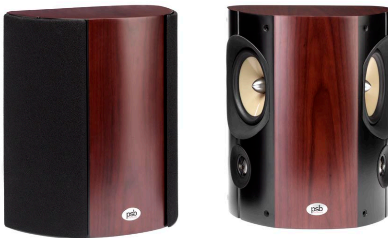
Eine elegante schwarze Textilbespannung verhüllt auch bei den Imagine S wahlweise den Blick auf ihre Treiber. Dank doppelter Hoch- und Tiefmitteltontreiber sowie zweier Lautsprecheranschlüsse kann die Imagine S auch vier Kanäle wiedergeben und so in einem 7.1-Setup für die Surround- und die Surround Back-Kanäle eingesetzt werden
